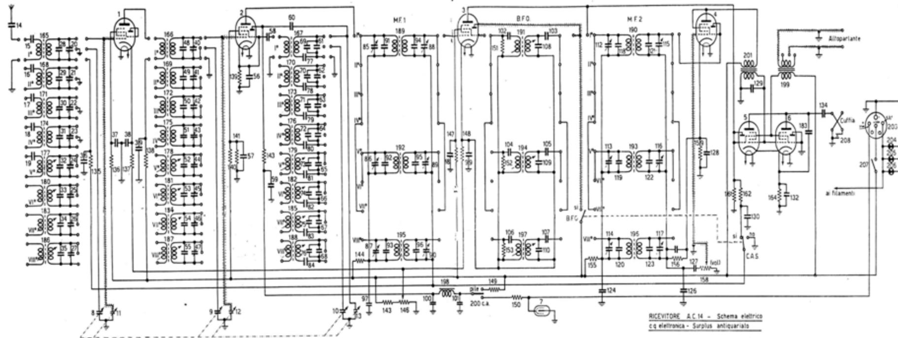
RICEVITORE A.C.14 - Schema elettrico
