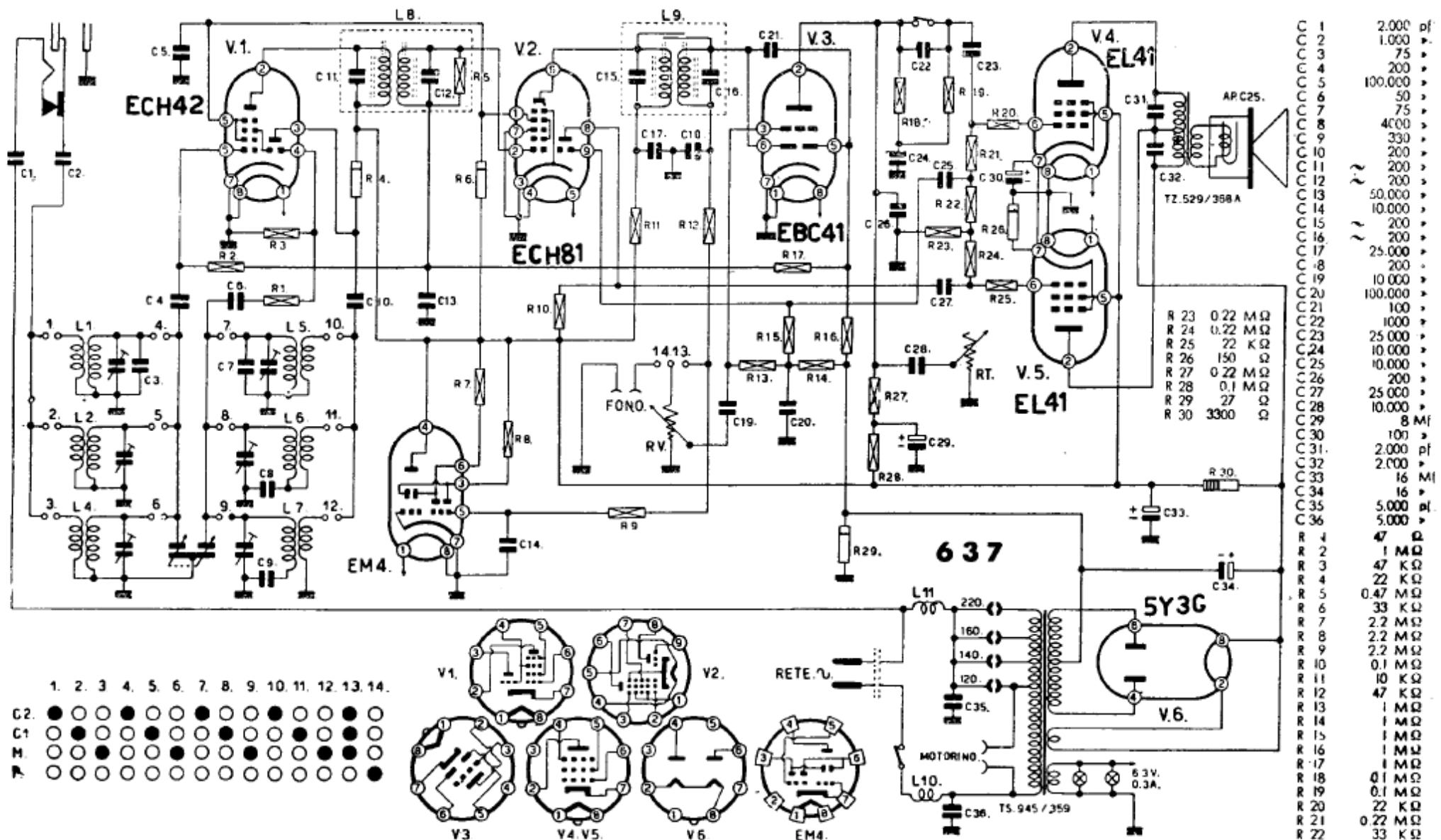
FIMI S.A. - PHONOLA - Mod. 637. Onde medie da 183 a 575 metri. Onde corte da 27,3 a 80 metri e da 15,8 a 28 metri. Media frequenza 470 kc/s. Consumo 80 watt. Potenza indistorta 9 watt. Montaggio della cordina come per il mod. 5532 F. Disposizione dei compensatori A.F. e bobine come per il mod. 5576.
