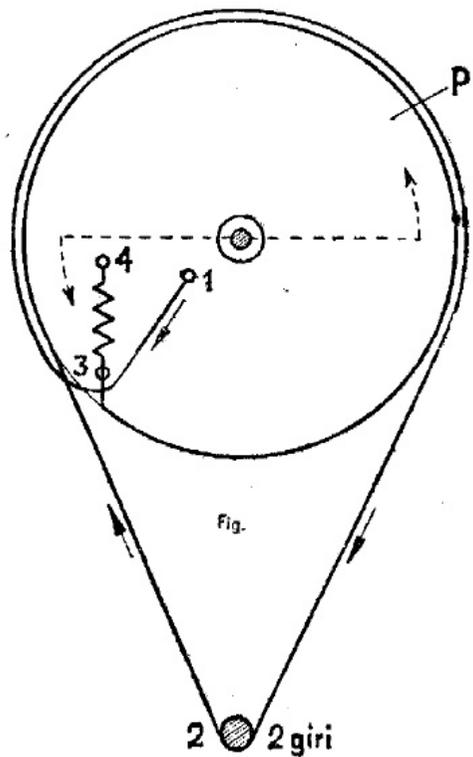
La figura 1), qui sotto riportata, illustra chiaramente il modo, come si deve applicare la treccia di comando dell'indice. La posizione della puleggia **p** corrisponde al condensatore variabile chiuso e telaio visto di fronte.
