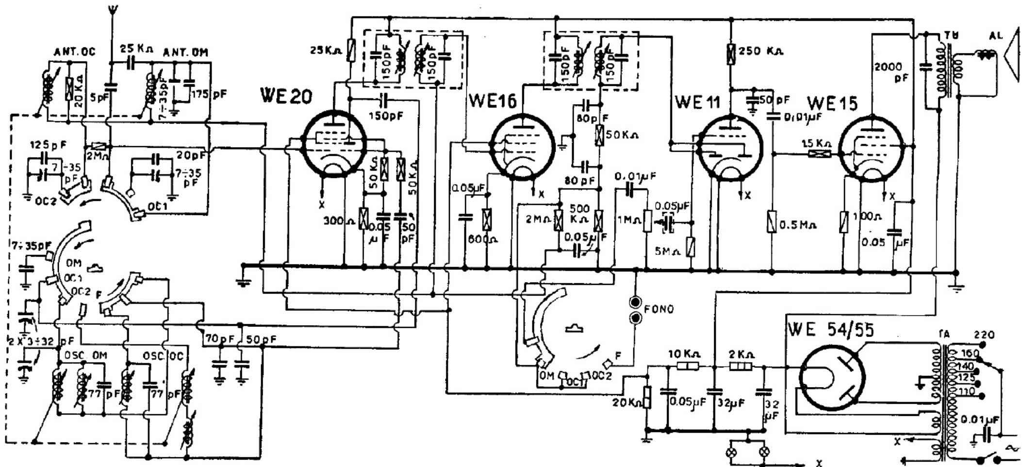
TELEFUNKEN - Mod. T50 e Mod. Mignon. Il mod. Mignon è senza controllo di tono ed è provvisto di inversore radio-fono. Media frequenza: 468 kc/s. Ricevitore a induttore variabile. Gamma media intera e due gamme onde corte.
