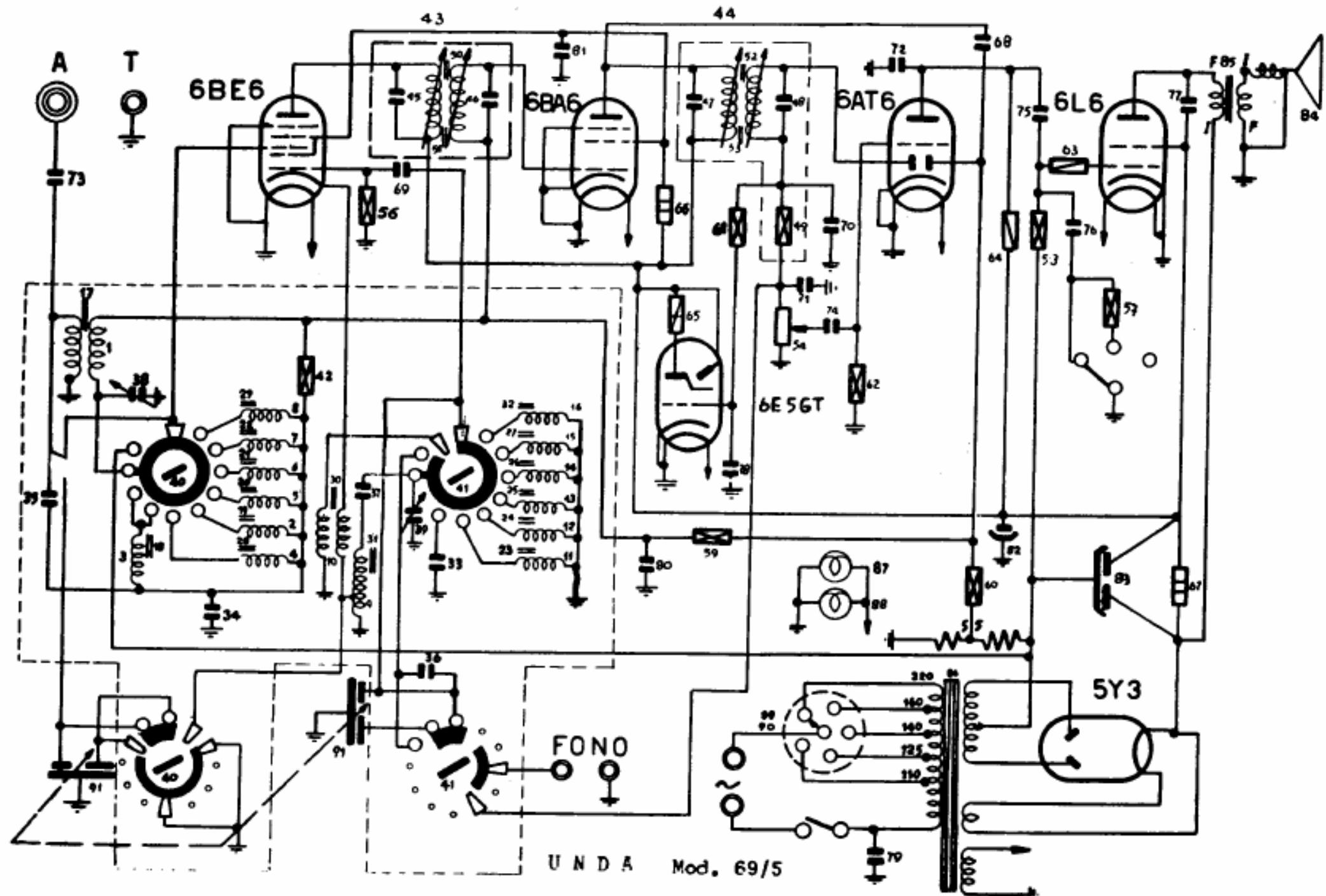
**UNDA RADIO - Mod. 69/5.** Una gamma onde medie da 182 a 578 m; una gamma medio-corte da 80 a 187 m e sette bande allargate ad onde corte di 16, 19, 25, 31, 42, 49, 75 m. Media frequenza a 467 kc/s. Potenza indistorta di uscita 3,5 watt. Potenza di uscita 6 watt. (V. a parte la tabella valori dei componenti).
