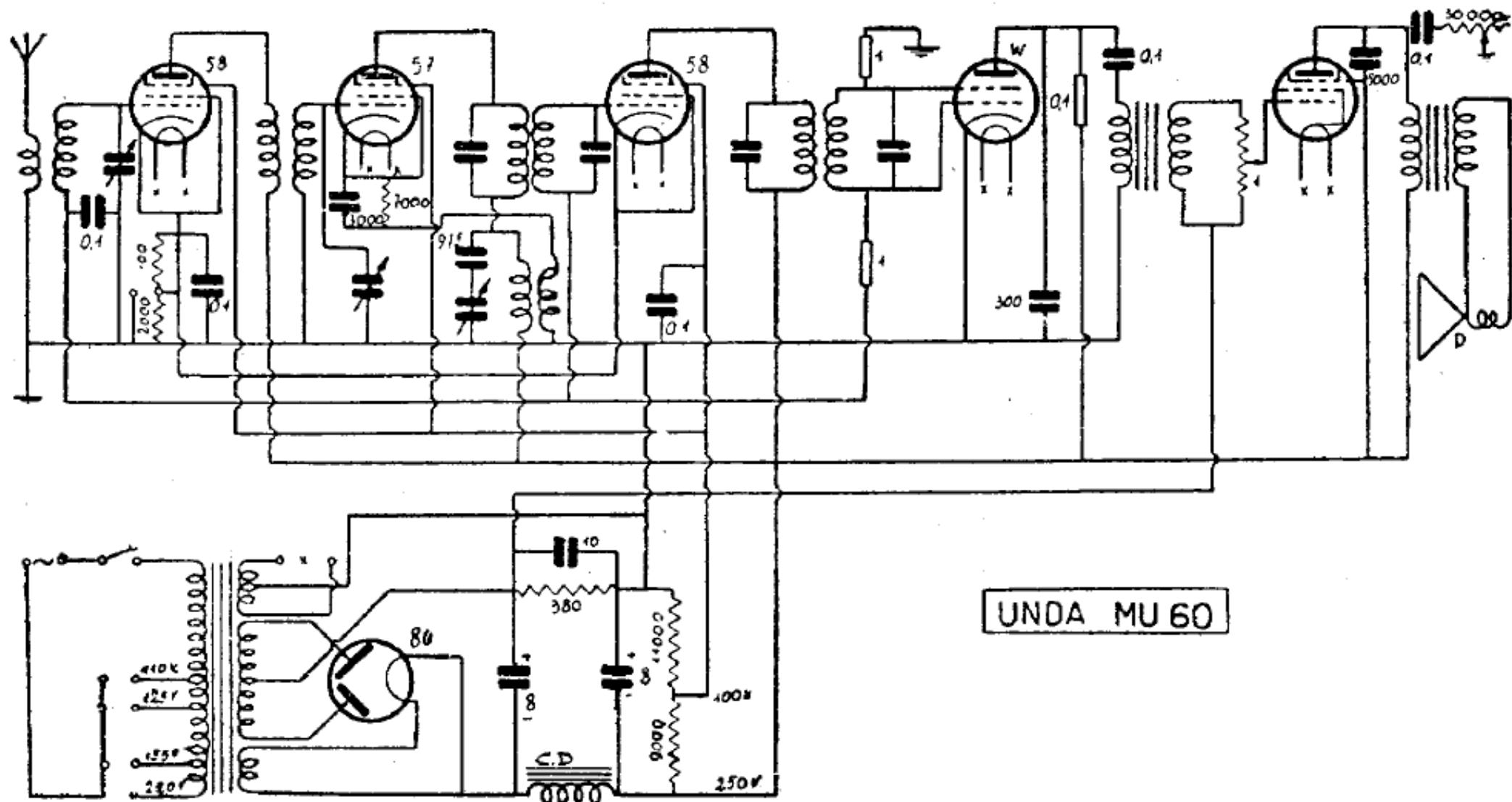
**UNDA RADIO.** — Mod. « MU 60 ». — La valvola rivelatrice è una Wunderlich, la quale può venir sostituita modificando il circuito (v. altri schemi) con una '57 o '27 o altra. — MF: 175 kHz. — Produzione 1933.
