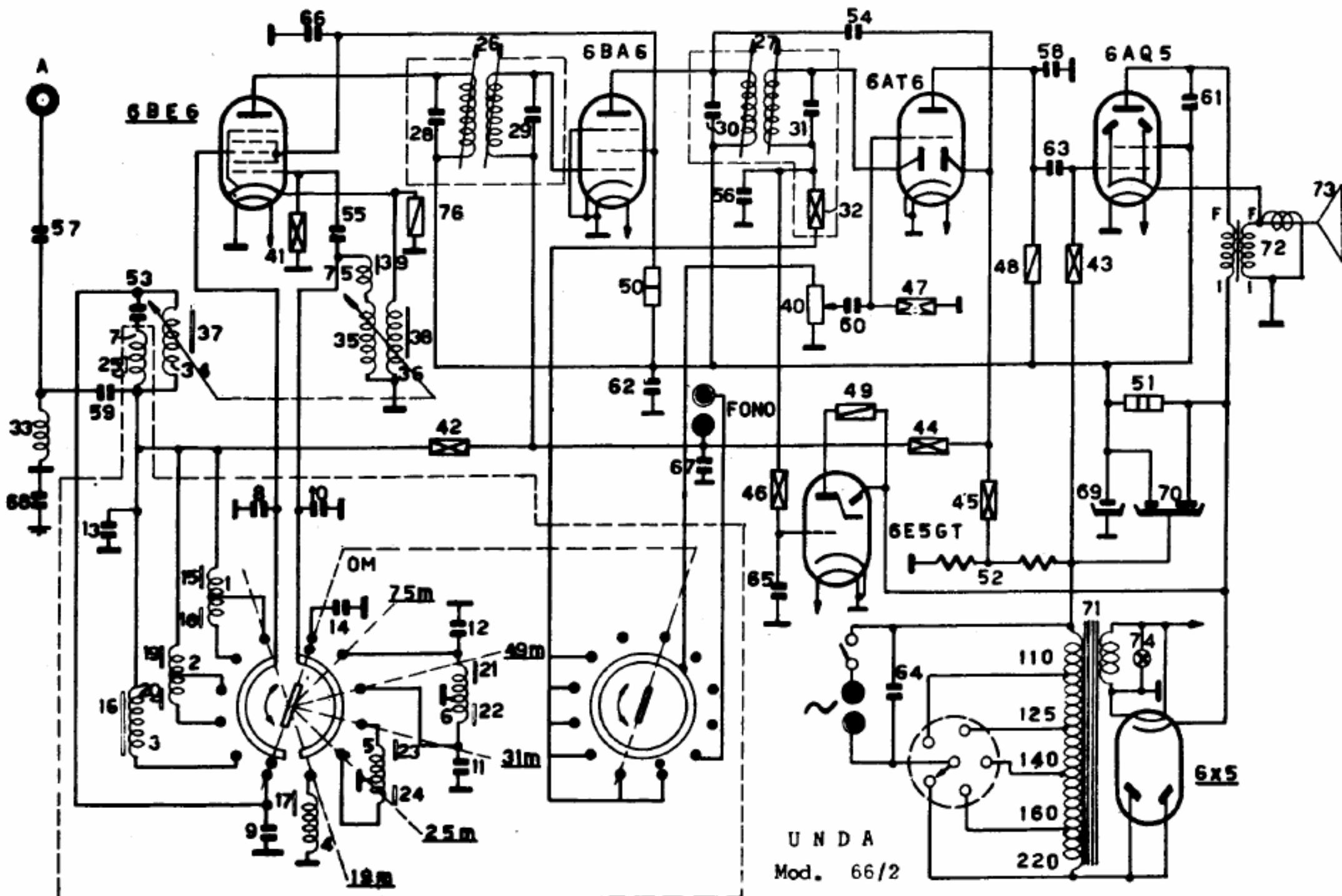
**UNDA RADIO . Mod. R 66/2.** Ricevitore con sintonia a permeabilità variabile. Una gamma onde medie e cinque bande allargate ad onde corte. Media frequenza 467 kc/s. Potenza indistorta di uscita 3 watt. Consumo 35 watt.
