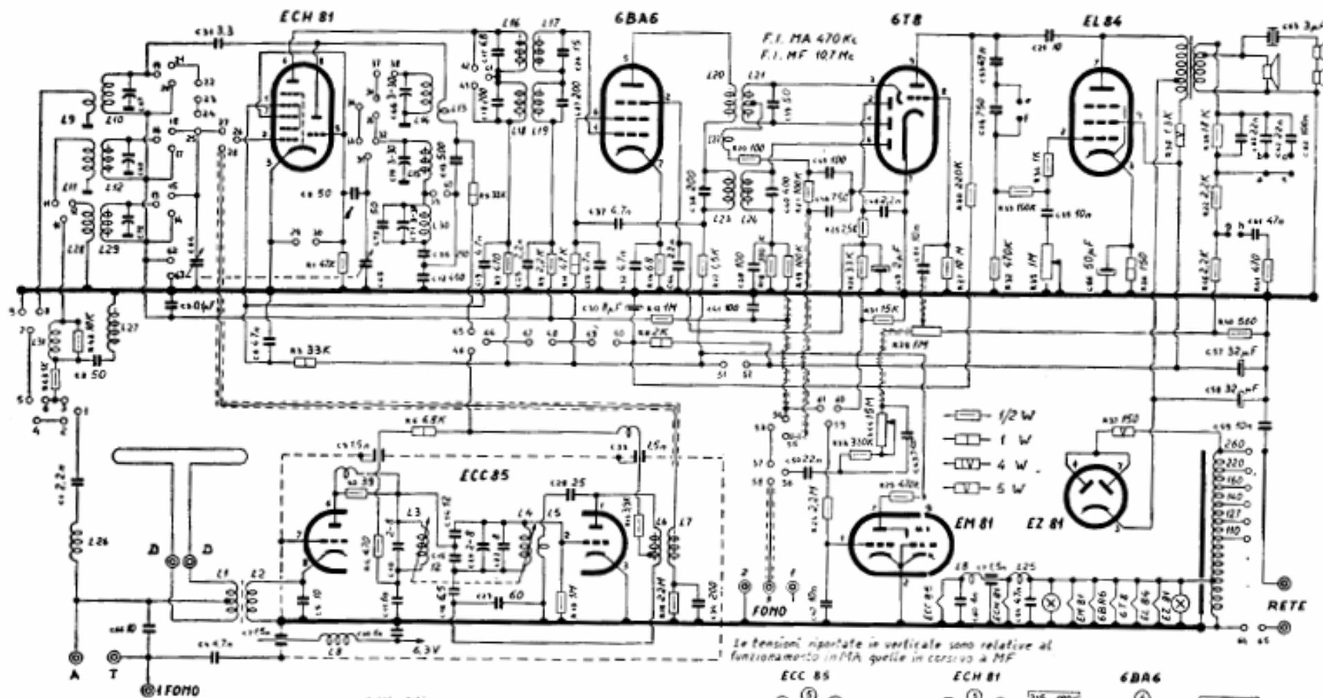
Le tensioni riportate in verticale sono relative al funzionamento in MA, quelle in corsivo a MF
