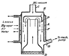
Fig. 21.28.—Langmuir's mercury-diffusion pump.
