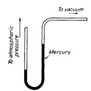
Fig. 21.10.—Mercury manometer.
